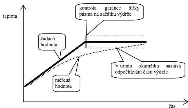
Šířku pásma **GSDE** lze nastavit v **konfigurační úrovni**, menu **sys**, parametr **gsde**.
