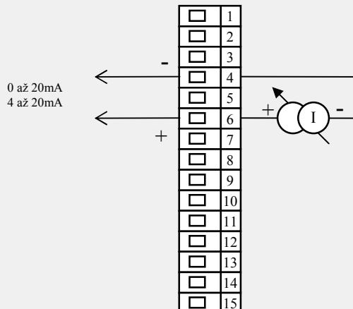
**Retransmit výstup je galvanicky oddělený od země přístroje**
