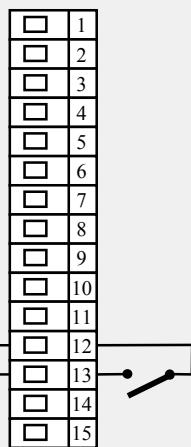
Výstup RELÉ je galvanicky oddělený od země přístroje. U tohoto výstupu je nutné vnější vodiče fixovat tak, aby v případě uvolnění vodiče ze svorky nedošlo ke snížení izolace mezi kategoriemi síťového napětí a bezpečného napětí.
