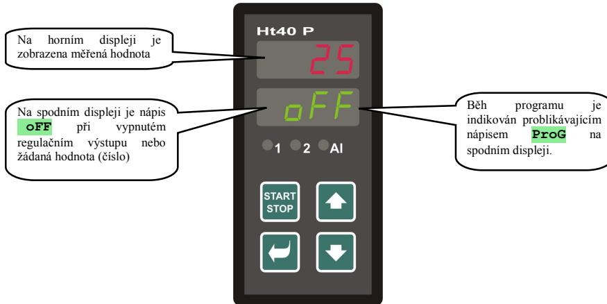
Na horním displeji je zobrazena měřená hodnota, na spodním displeji je zobrazen nápis **OFF** při vypnutém regulačním výstupu nebo žádaná hodnota.
